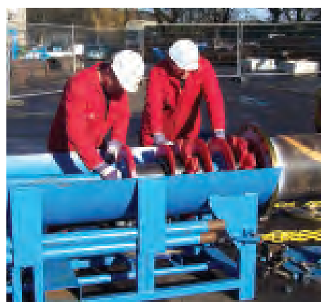
Испытание специализированного внутритрубного снаряда
