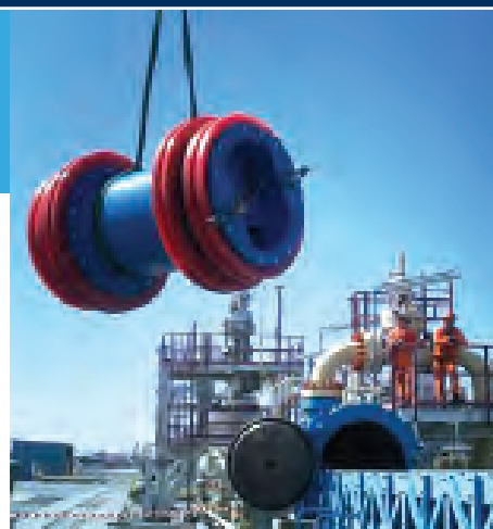
Скребок с металлическим основанием, готовый к запуску
