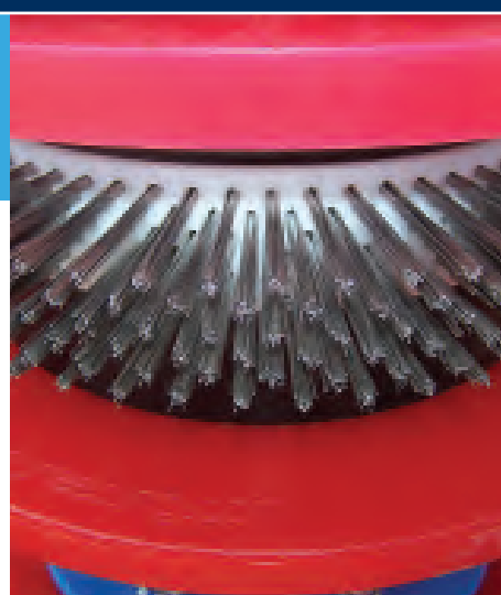
Щетки с эффектом памяти на внутритрубных снарядах
